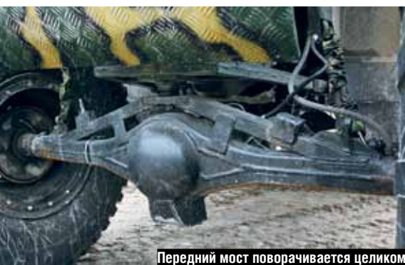
Передний мост поворачивается целиком
