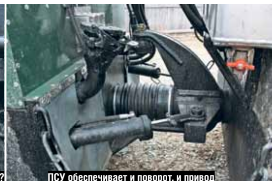
ПСУ обеспечивает и поворот, и привод
